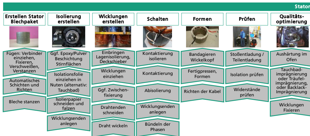
Abbildung 23: Wesentliche Prozessschritte in der Statorherstellung (Grafik: Fraunhofer IAO)
