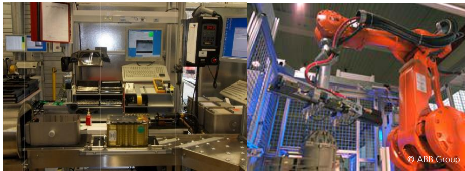
Abbildung 34: Manuelles und automatisiertes Einsetzen der Zellmodule (Busch, 2011), (Schmid, 2010)
