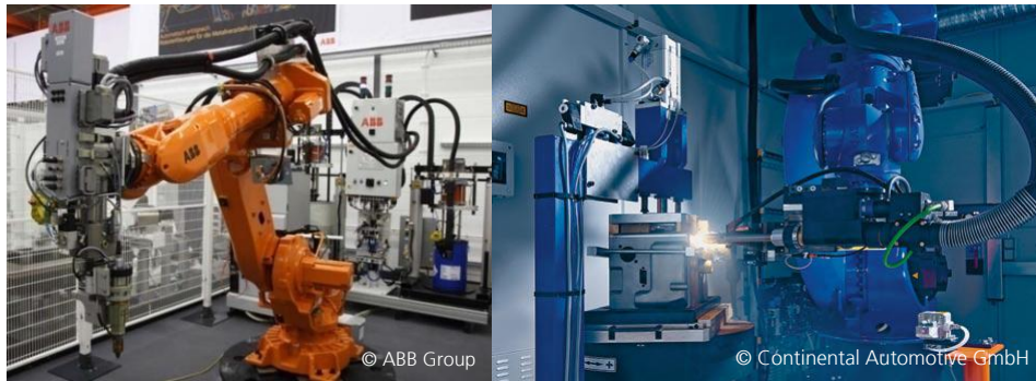
Abbildung 35: Automatisierte Dichtungsapplikation und Schweißprozesse bei der Batteriedeckelmontage (Busch, 2011), (Keller, Birke, Schiemann, & Möhrstädt, 2009)
