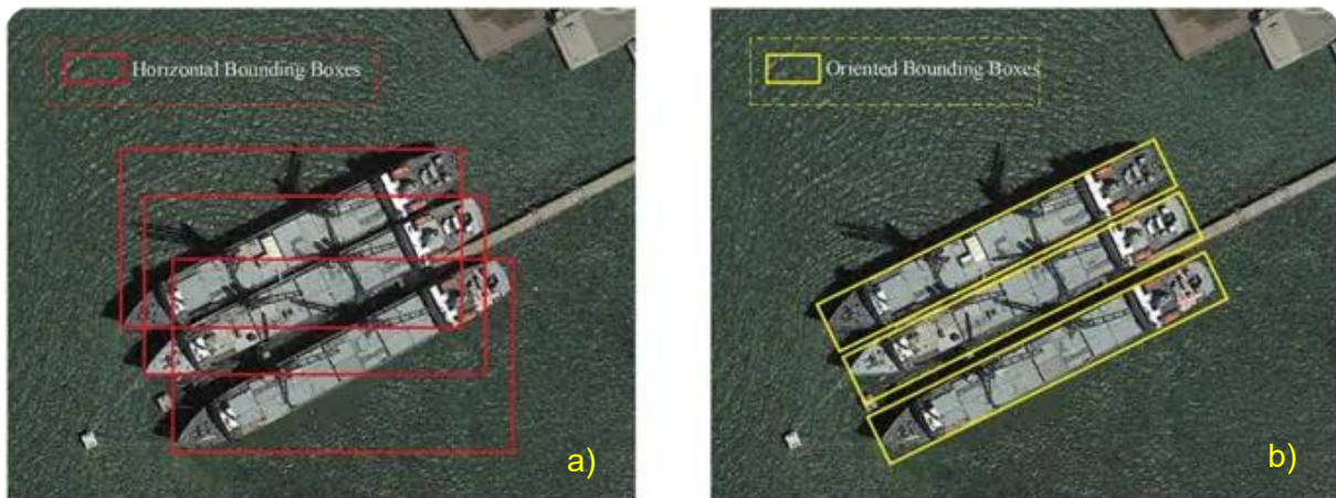
Abbildung 7 Vergleich zwischen (a) „normalen“ Begrenzungsrechtecken und (b) orientierten Begrenzungsrechtecken; in beiden Bildern ist jedes Schiff von einem Begrenzungsrechteck umgeben, im linken Bild ist durch die hohe Überdeckung der Rechtecke die Zuordnung herausfordernd, im rechten Bild orientiert sich die lange Achse der Rechtecke an den Schiffen und verbessert die Übersichtlichkeit und die Genauigkeit (Quelle: Guan, Q., Qu, Z., Zeng, M., Shen, J., & Du, J. (2021). CGP Box: An effective direction representation strategy for oriented object detection in remote sensing images. International Journal of Remote Sensing , 42(17), 6666–6687. https://doi.org/10.1080/01431161.2021.1941389 )
