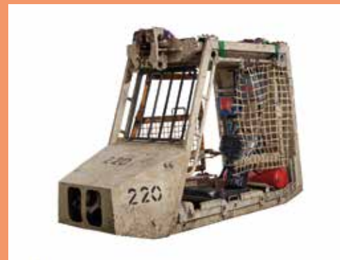
Fahrerkabine einer Dieselzuglaufkatze aus dem Bergwerk Prosper-Haniel, Bottrop (stillgelegt 2018) © Stiftung Haus der Geschichte der Bundesrepublik Deutschland, Bonn, Foto: Axel Thünker
