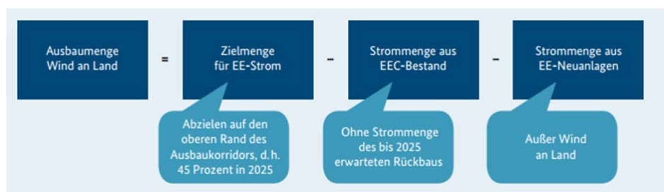
Abbildung 21: Formel zur Berechnung der Ausschreibungsmenge von Windenergie an Land
