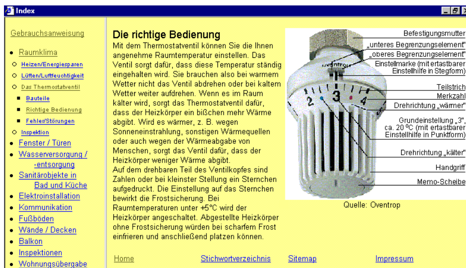
Abb. 14 Hinweise für Mieter: Bedienung des Heizkörper-Thermostatventils; [GISMO, S. 68]
