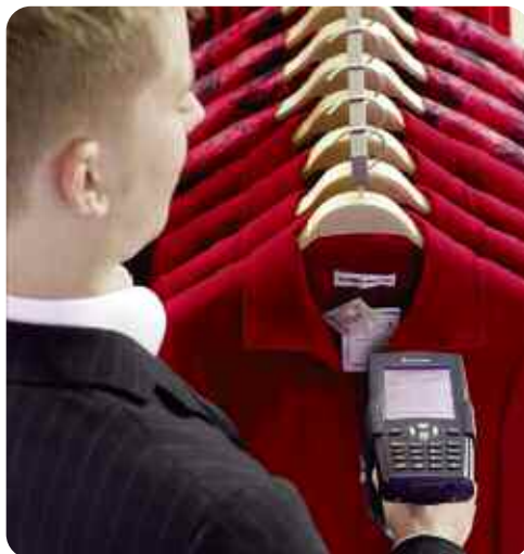
Abb. 3: Beispiele für RFID-Lesegeräte und RFID-Handscanner (Foto: METRO AG)
