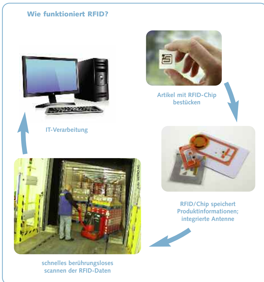
Abb. 2: Funktionsweise der RFID-Technik
